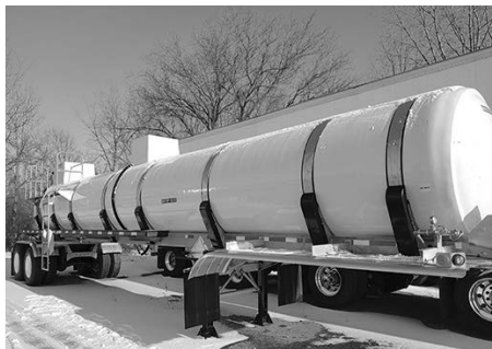
(2) '20 Brenner, 5400-gal., FRP trlr., S.S. frame, air ride.
